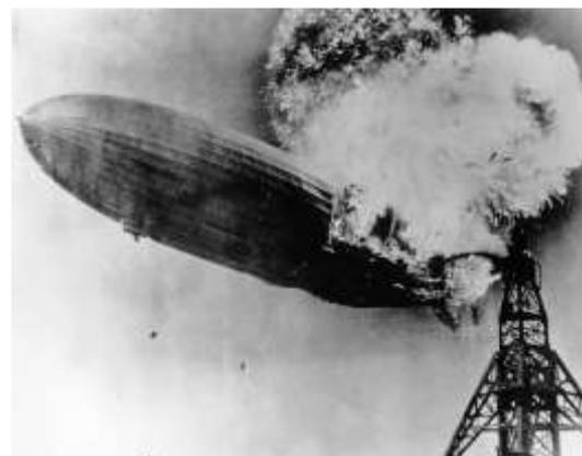
El dirigible podía cargar 200 000 m<sup>3</sup> de gas en 16 bolsas (14 de hidrógeno y 2 de aire). Normalmente el gas se escapaba a través de la envoltura que cubría el tanque con hidrógeno a un ritmo tal que una pérdida del 50% en 10 días era normal. Cada 10 días, el 50% del gas desaparecía.
