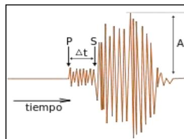
Las ondas P hacen vibrar el medio terrestre en la misma dirección que la del desplazamiento de la onda, son ondas de compresión y expansión. De velocidad de propagación muy rápida (de 5 a 11 km/s), son las primeras en aparecer en un sismograma. A continuación, llegan las llamadas ondas **S**, que hacen vibrar el medio terrestre en sentido perpendicular a la dirección de su desplazamiento. Basándose en estos hechos, Richter desarrolló la siguiente ecuación:
