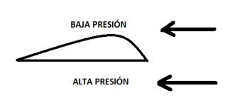
En esta figura se muestra el perfil de un ala de avión. Cuando el avión se mueve con cierta velocidad, se genera sobre el ala una zona de baja presión y bajo la misma una zona de alta presión. Al juego de estas dos presiones se debe la sustentación, una fuerza que se opone al peso del avión. Esta fuerza L
