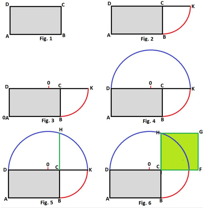
Explicación: Primero se prolonga la recta CD en una longitud igual a BC con la ayuda de un compás (fig. 2). De este modo tenemos el segmento DK y se determina el centro O (fig. 3) (la determinación del centro se hace con compás).
