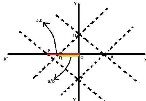
Plegar una línea que pase por  $A$  y por  $B$ . Plegar una línea que pase a través de  $U$  paralela a  $AB$ . Sea  $Q$  el punto de intersección de esta línea con  $X'X$ . Entonces  $OQ$  representa el cociente  $a/b$  en magnitud y signo.
